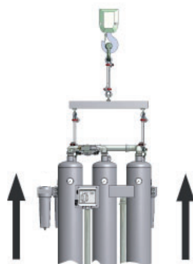
II: Aufstellen mit Kran
